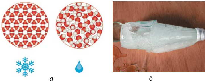
Мал. 7.5. У рідкій воді молекули води розташовані неупорядковано та близько одна до одної; у льоду молекули розташовані впорядковано й на більшій відстані, тому лід легший за воду (а). Під час замерзання вода розширюється, внаслідок чого закрита скляна пляшка з водою в морозилці тріскається (б)
