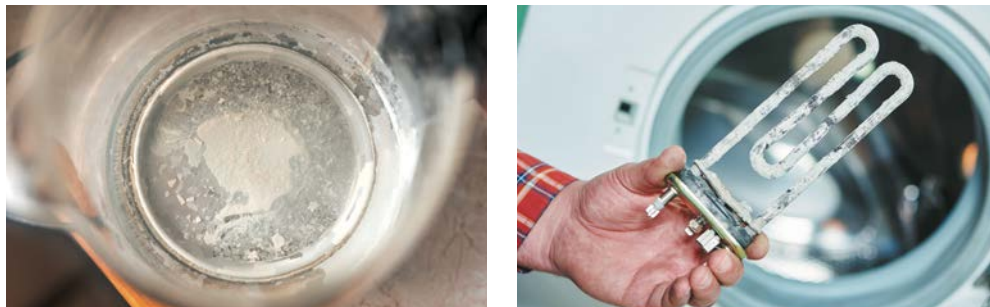
Мал. 34.6. Накип, що утворюється на дні чайника та нагрівному елементі пральної машини
