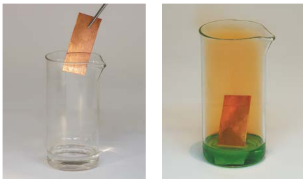
Мал. 25.1. Взаємодія міді з концентрованою нітратною кислотою
