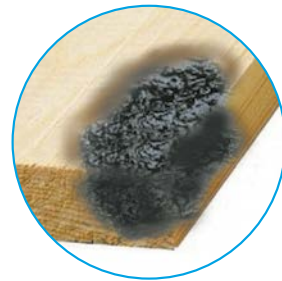
Мал. 22.2. Обвуглювання деревини концентрованою сульфатною кислотою
