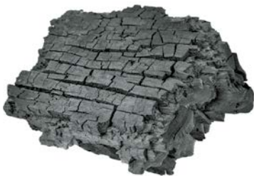
Мал. 28.6. Деревне вугілля зберігає структуру деревини
