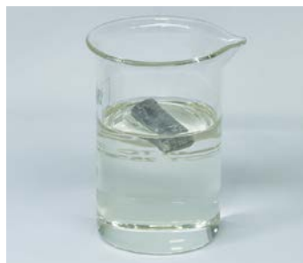
Мал. 31.6. У літій найменша серед усіх металів густина ( 0,53\text{ г/см}^3 ), він плаває не лише на поверхні води (як інші лужні метали), а й на поверхні гасу ( 0,81\text{ г/см}^3 )
