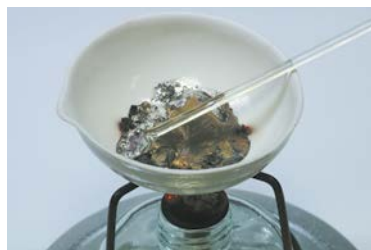
Мал. 32.1. Сплав Вуда плавиться за значно нижчою температурою, ніж його складові
