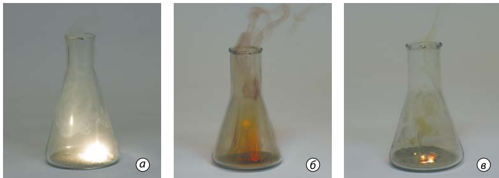
Мал. 16.1. Взаємодія з хлором магнію (а), заліза (б) і міді (в)
