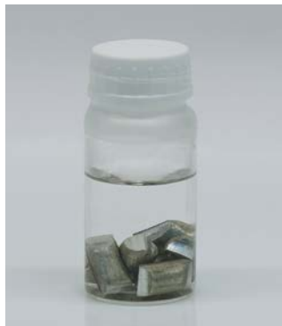
Мал. 33.1. Натрій зберігають під шаром рідких вуглеводнів
