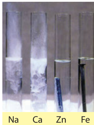
Мал. 36.3. За звичайних умов натрій та кальцій активно взаємодіють з водою з виділенням водню, а цинк та залізо не взаємодіють
