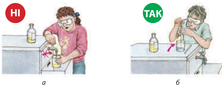
Мал. 35.2. Розбавлення кислоти водою: а — неправильно, б — правильно
