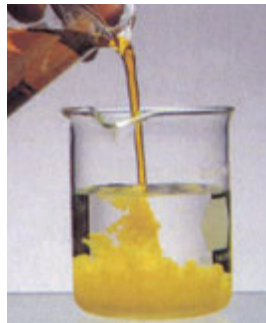
Мал. 38.4. Взаємодія калій йодиду з плумбум(II) нітратом з утворенням жовто-золотистого осаду плумбум(II) йодиду
