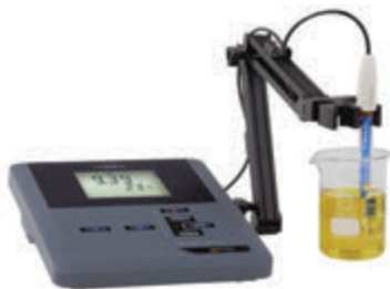
Мал. 43.1. рН-метр визначає наявність кислот та основ у розчинах
