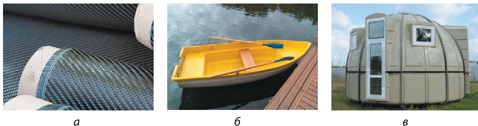
Мал. 40.1. Використання композитних матеріалів: вуглецеву тканину (вуглеволокно) (а) використовують для армування деталей велосипедів та автомобілів, зі склопластика виготовляють корпуси байдарок та невеликих човнів (б) і навіть цілі будинки (в)
