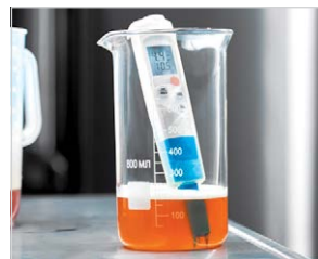
Мал. 11.4. Для вимірювання рН розчинів використовують спеціальні прилади — рН-метри: а — лабораторний (стаціонарний); б — портативний
