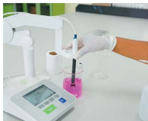
Мал. 11.4. Для вимірювання рН розчинів використовують спеціальні прилади — рН-метри: а — лабораторний (стаціонарний); б — портативний
